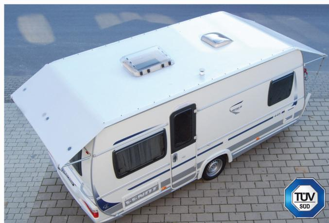
PROTEC-Swiss ist ein Schutzdach für alle Wohnwagentypen, das zum Fahren nicht demontiert werden muß. Die Dachplane besteht aus einem Grundgewebe und einer 4mm starken PVC-Schaumschicht. Die Umstellung von der Stand- auf die Fahrposition erfolgt mit wenigen Handgriffen. Die Dachmontage erfolgt ohne zusätzliche Bohrungen am Fahrzeug.
